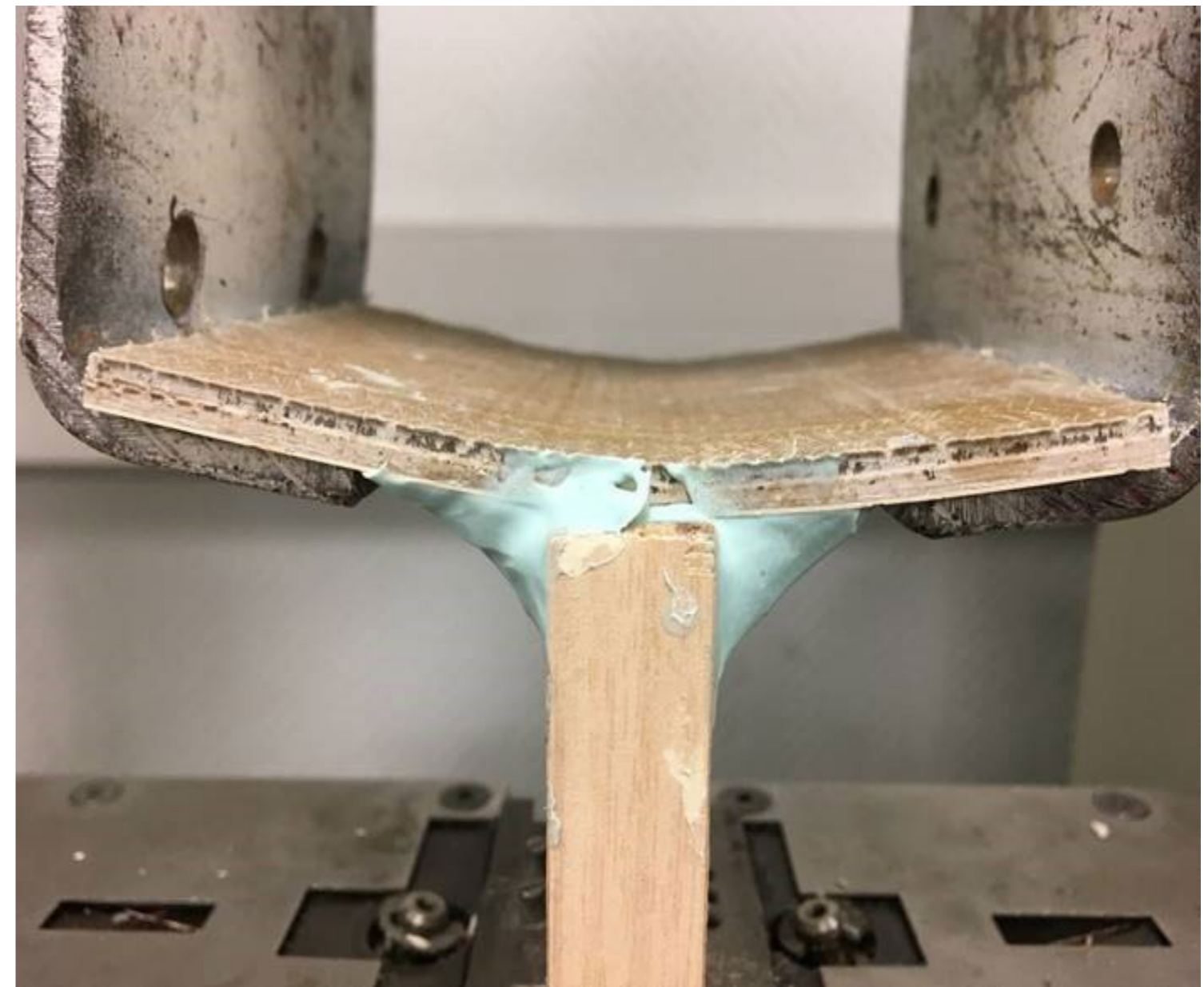
Échantillon d'essai composite cloison. Grâce à sa déformation élastique unique, Adekit A236 absorbe la contrainte appliquée sur la structure : LE COMPOSITE N'EST PAS ENDOMMAGÉ.
